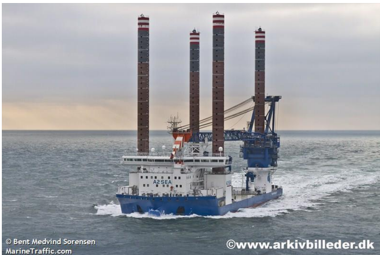
Sea Installer under vejs (før montage af helikopterdæk og forlængelse af kranarm)
