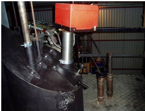
Figur 8: Tv.: Oliebrænderen på plads øverst i gasgeneratoren. Th.: Flammen fra det forlængede oliefyr brænder lige over den øverste del af gasgeneratorens keramiske elementer.
