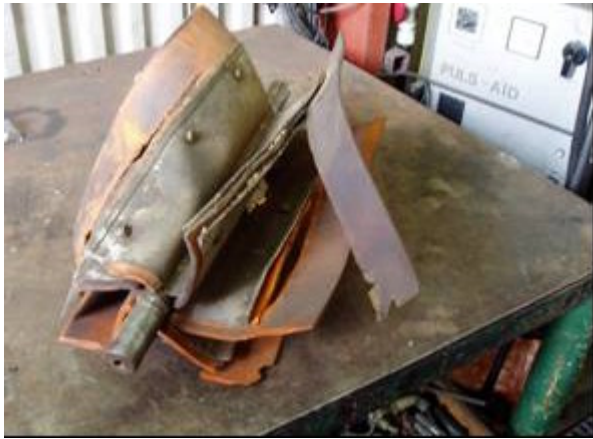
Figur 10: Celleslusens rotor kunne ikke holde til blive brugt til brændselsflis. Billedet til venstre viser en af de adskillige gange, hvor den både var blevet deformeret skulle have skiftet gummilapperne. Til højre ses en rotor, der er ved at få monteret nye gummilapper efter være blevet rettet op.
