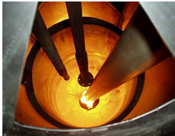
Figur 8: Tv.: Oliebrænderen på plads øverst i gasgeneratoren. Th.: Flammen fra det forlængede oliefyr brænder lige over den øverste del af gasgeneratorens keramiske elementer.
