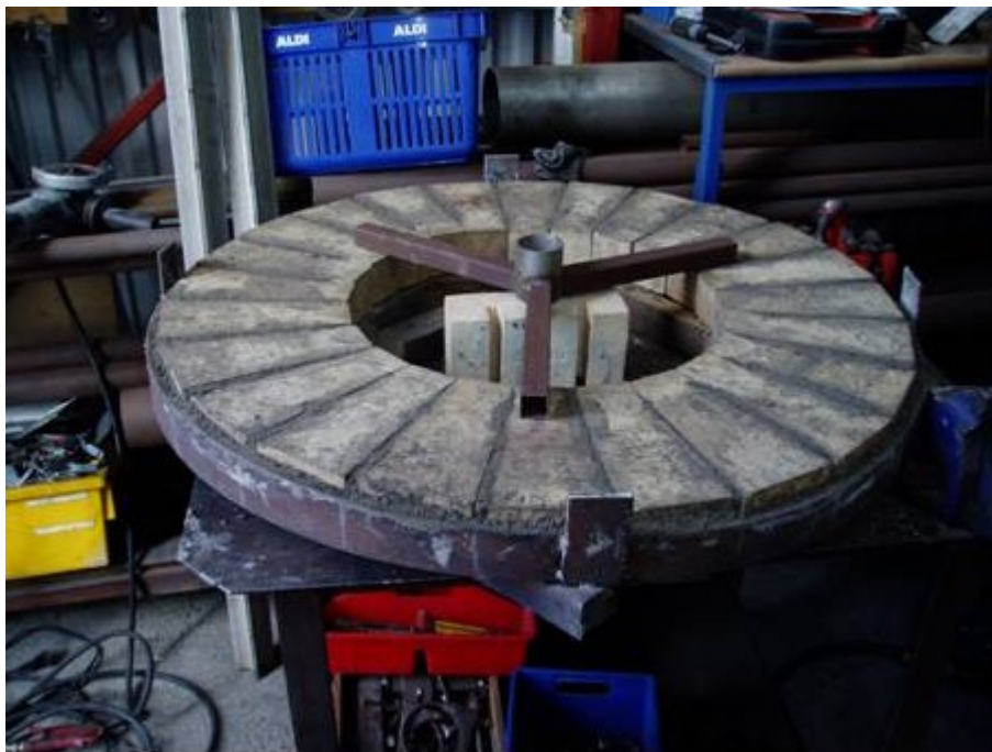
Figur 3: Der blev fremstillet og monteret et keramisk element til forlængelse af gasgeneratorens kokszone.
