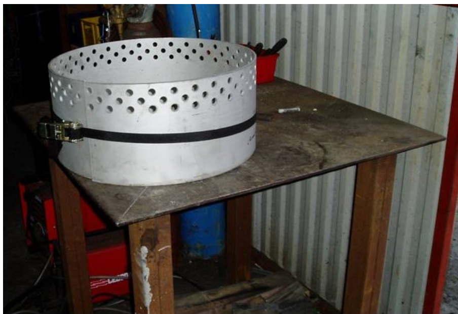
Figur 5: Efter det første forsøg med det keramiske element til forlængelse af gasgeneratorens kokszone blev det erstattet af et svøb i varmemfast stål.
