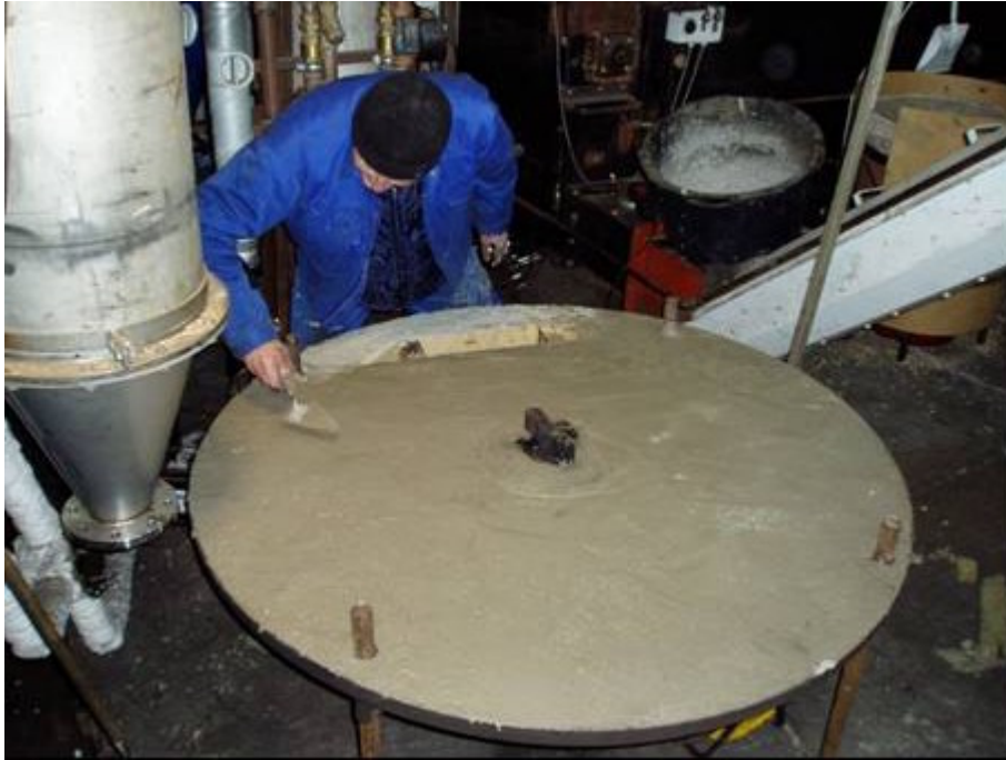
Figur 4: På Castoranlægget udgør denne isolerede plade den nederste del af gas-kammeret. Smeden står bøjet over det hul hvorigennem koksen føres hen til det våde askeudtag. Han er netop blevet færdig med at flytte hullet længst muligt væk fra risteområdet.
