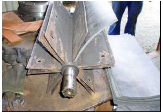
Figur 10: Celleslusens rotor kunne ikke holde til blive brugt til brændselsflis. Billedet til venstre viser en af de adskillige gange, hvor den både var blevet deformeret skulle have skiftet gummilapperne. Til højre ses en rotor, der er ved at få monteret nye gummilapper efter være blevet rettet op.
