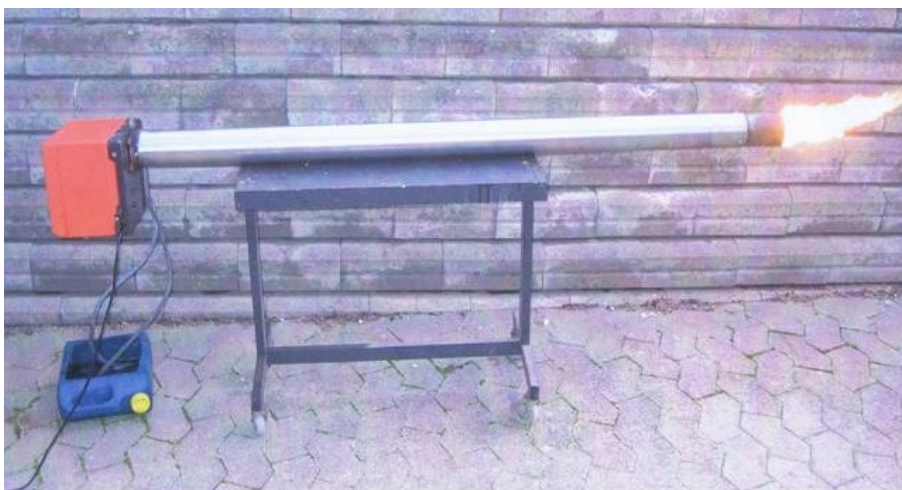
Figur 7: Første udendørs test af det specielt designede oliefyret, der let kan monteres ved opvarmning af gasgeneratoren.
