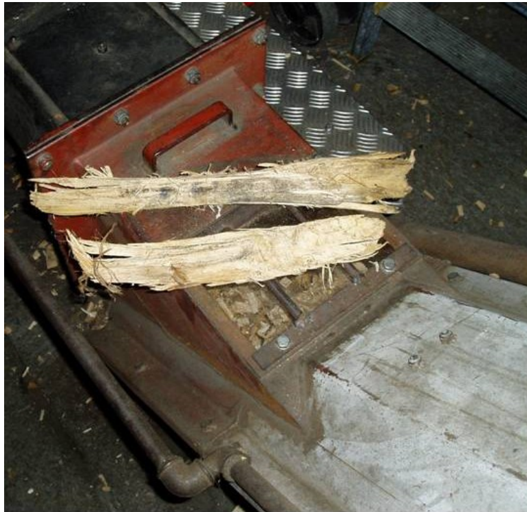
Figur 14: Også en slags brændselsflis. Disse stykker blev fanget og lagt til skue ovenpå en af transportsneglene. Forbavsende mange stykker i den størrelse passerer faktisk hele vejen igennem, men der også en del, der sætter sig fast, så anlægget automatisk lukker ned.
