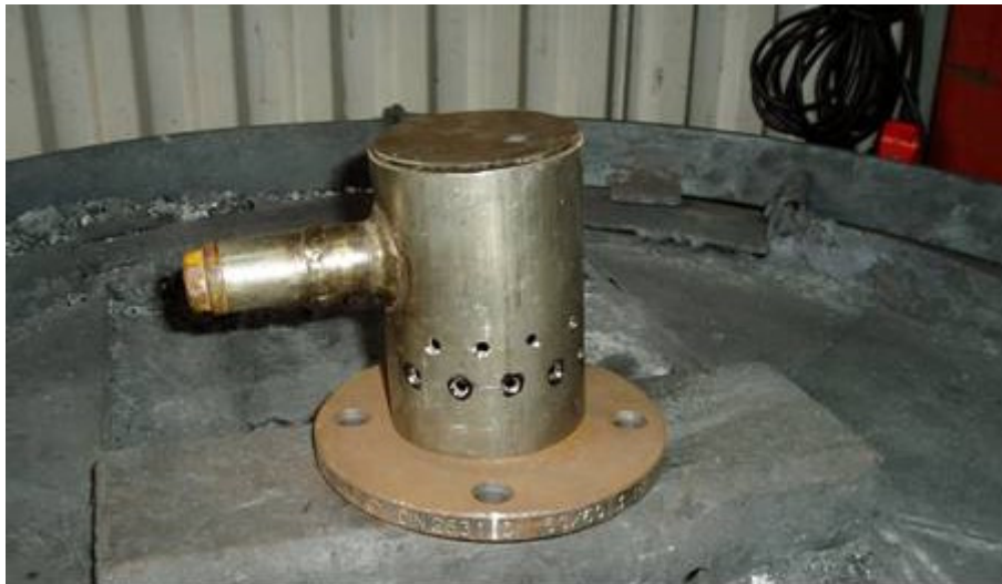
Figur 6: Stålelement med huller, der blev brugt til forsøg med lufttilførsel direkte ind i kokszone.
