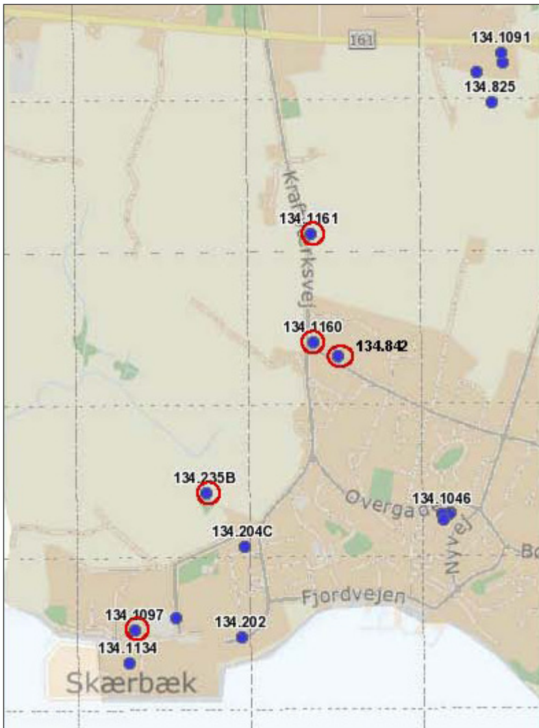
Figur 5-24: Skærbækværkets vandindvindingsboringer (markeret med rød cirkel): 134.1160, 134.1161, 134.842 samt 134.235B. Boring 134.1097 er en brakvandsboring. De resterende boringer ved Skærbækværket er sløjfet. Boringerne 134.825 og 134.1091 tilhører Børup Vandværk mens boringen 134.1046 m.fl. tilhører Skærbæk Vandværk.
